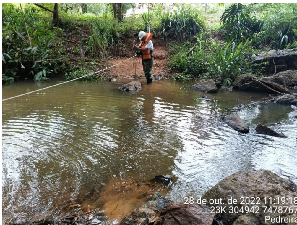
Foto 3.2.1-1. Medição de vazão com molinete fluviométrico.
