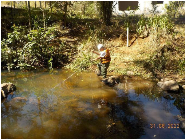
Foto 3.2.1-1. Medição de vazão com molinete fluviométrico.
