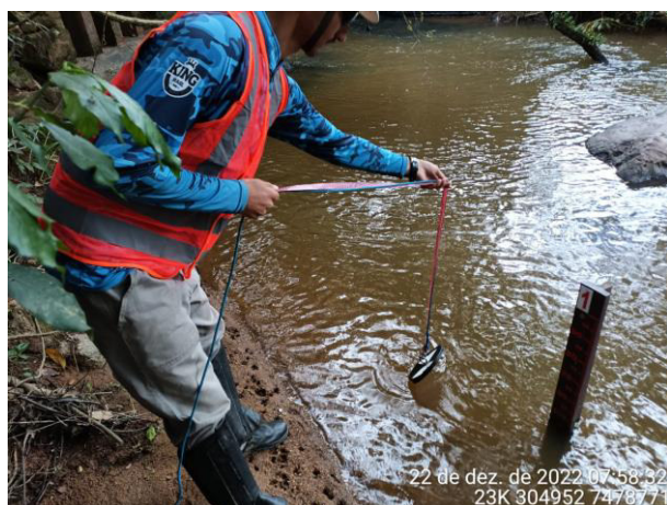
Foto 11 – Medição de transparência com disco Secchi. (Data: 22/12/2022).
